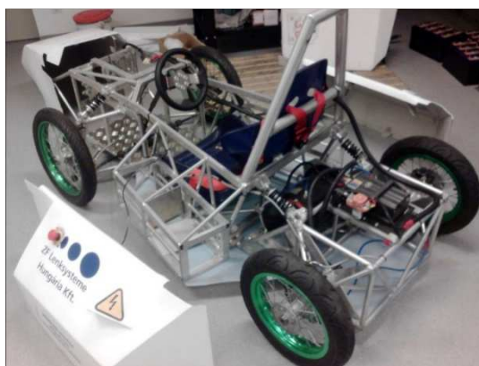
2. ábra. Az autó jelenlegi állapota, burkolat és akkumulátor nélkül
